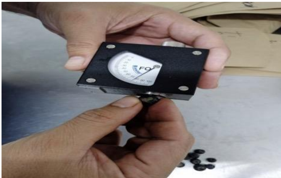
Figura 17. Durómetro Baxlo 53505/FO.
